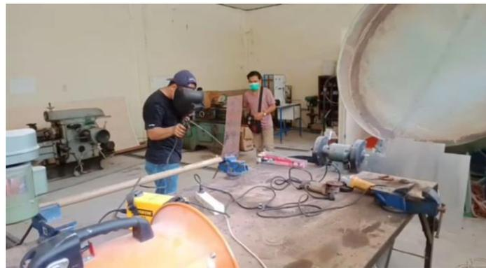
Gambar 4. Pengelasan plang besi dengan tiang besi
